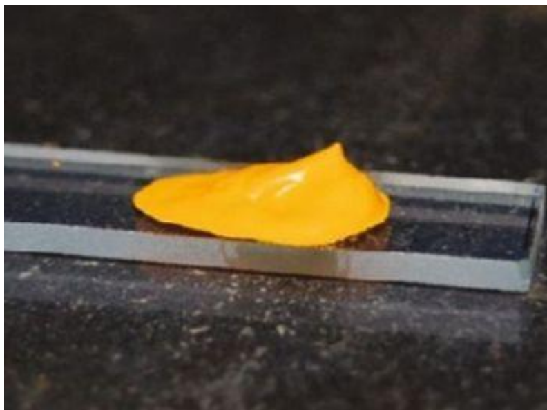
Рисунок 3.4 – Фарба на основі квантових точок
