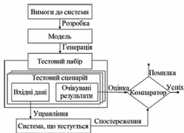
Рис. 1. Генерація сценаріїв тестування на основі моделі веб-застосунку
