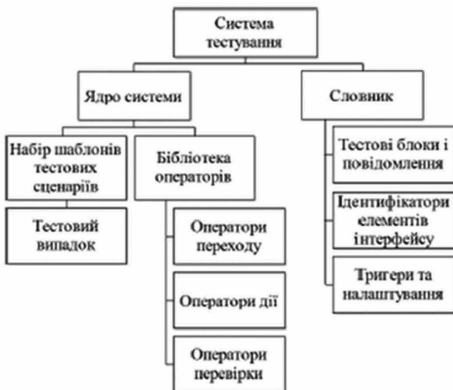
Рис. 2. Структура системи автоматичного тестування з використанням шаблонів
