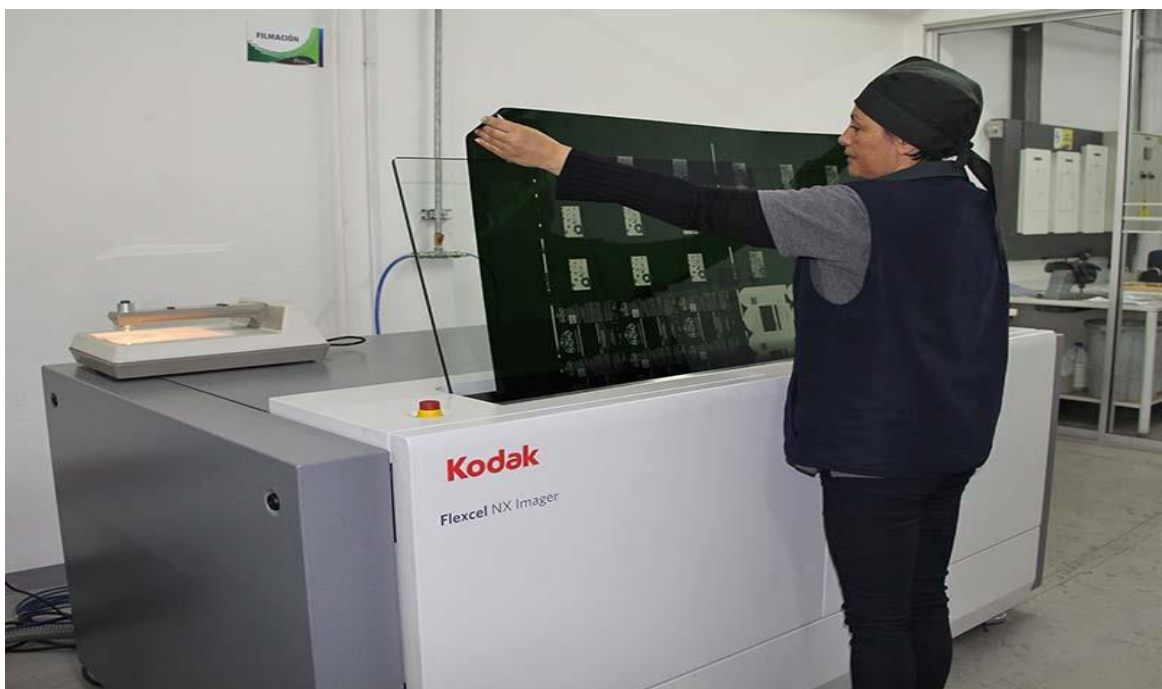
Рисунок 4.1 – Машина для виводу негативу (flexcel NX Imager Kodak) за технологією CtP
