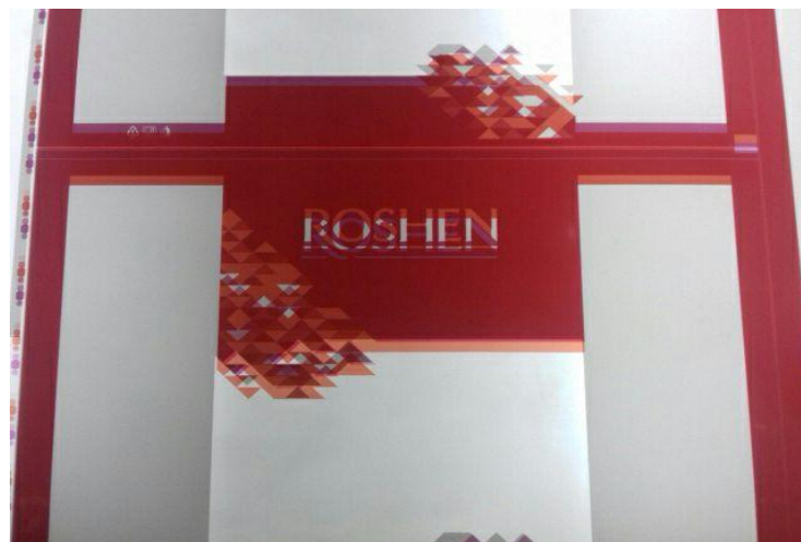
Рисунок 5.3 – Приклад першого відбитку з не суміщенням фарб
