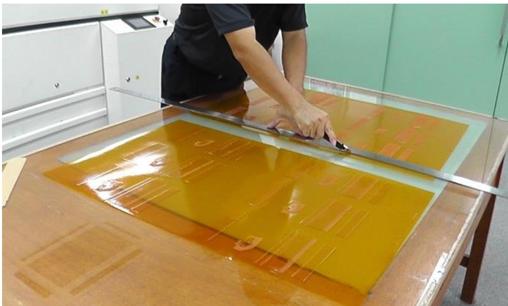
Рисунок 4.4 – Порізка форми-кліше, заключна операція
