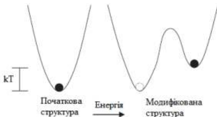
Рисунок 2.4 – Зміна хімічної структури внаслідок поглинання енергії молекулою
