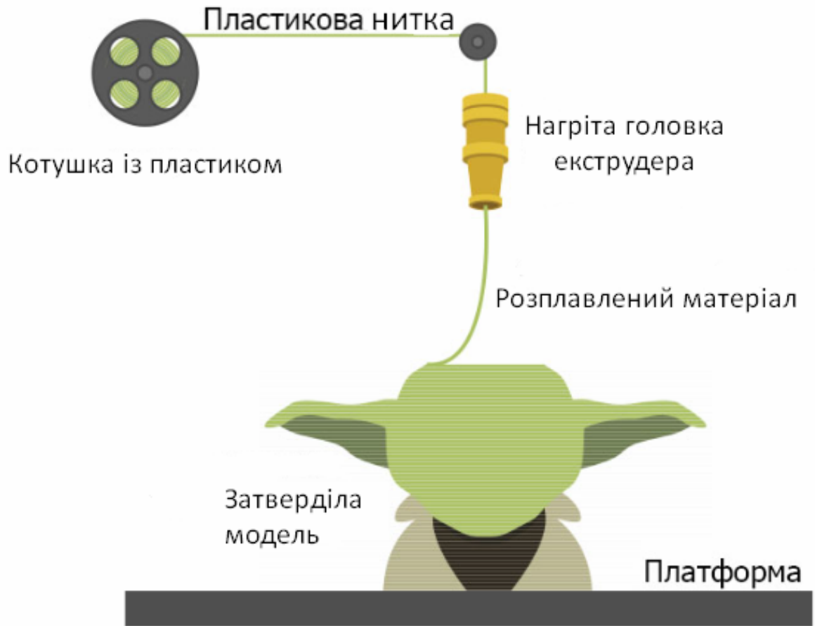
Рисунок 2 - Принцип роботи технології FDM/FFF
