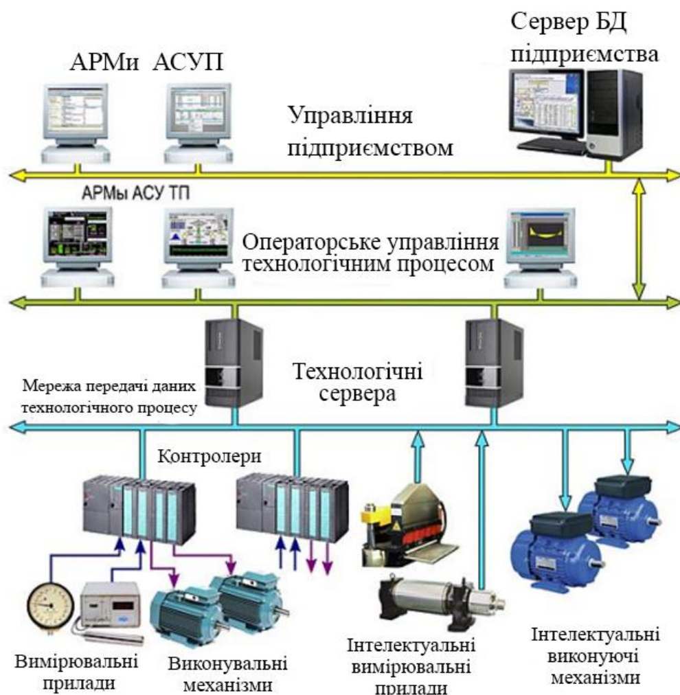
Рисунок 3.1 – Структура сучасної промислової системи автоматизованого управління виробництвом.
