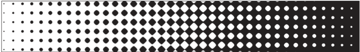
Рисунок 2.4 – Перетворення форми растрової точки за евклідовим законом
