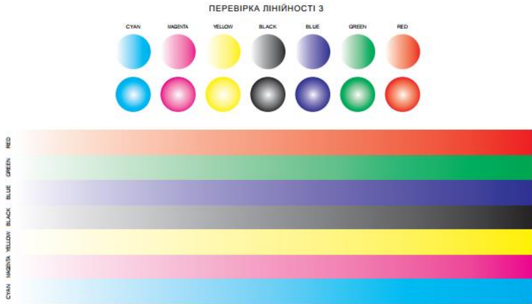
Рисунок 4.5 – Тест-об'єкт для контролю показника «Градаційна передача»
