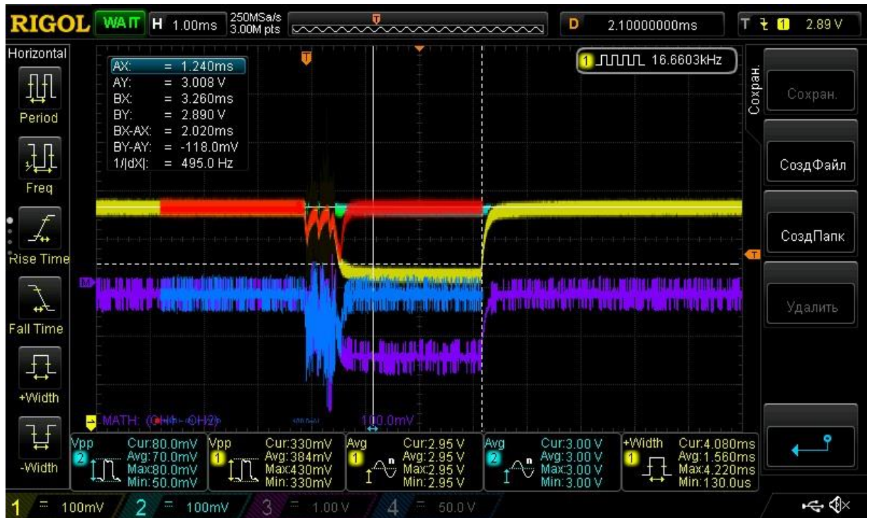
Рисунок 7.3 – Зведена осцилограма падіння напруги на резисторі для блоку керування у активному режимі роботи
