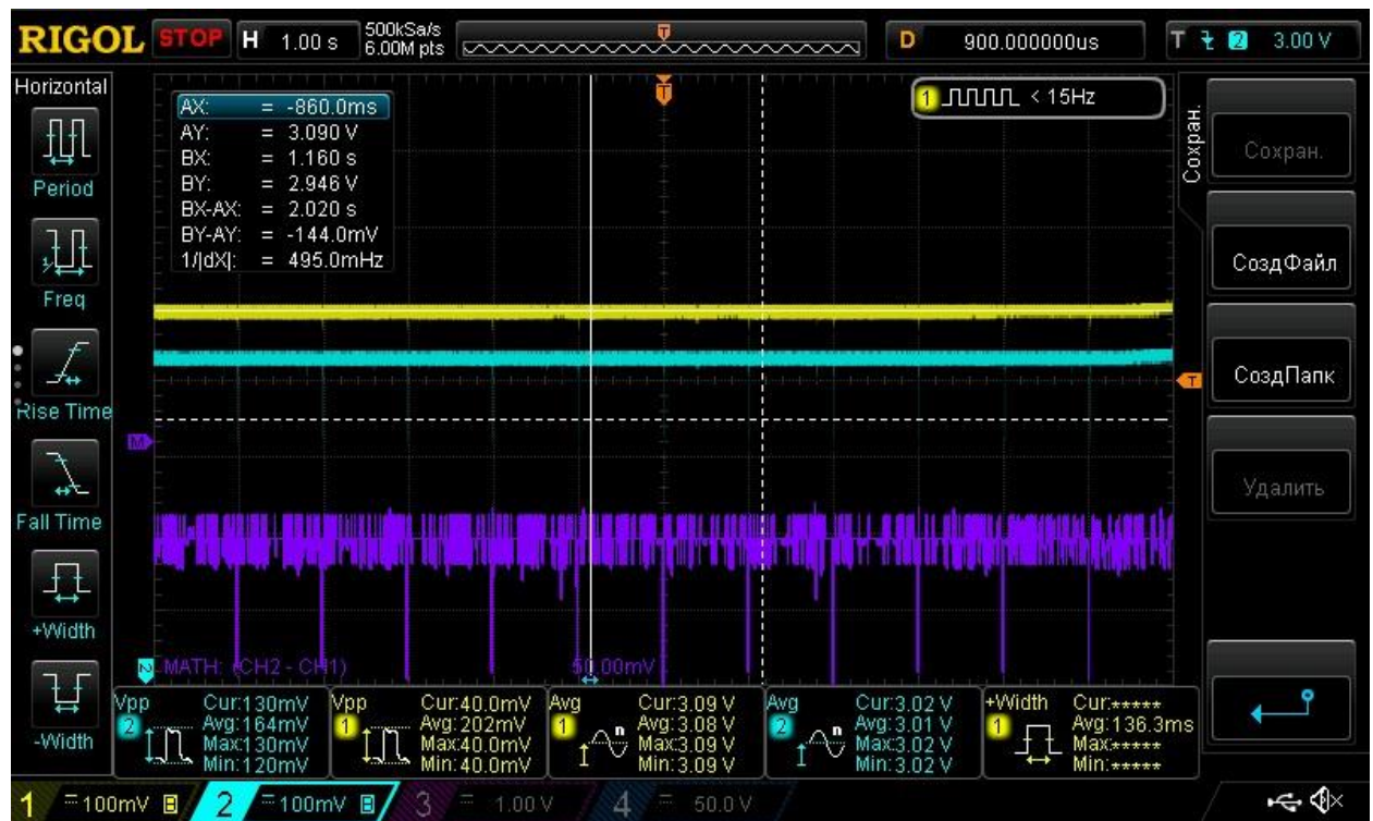
Рисунок 7.1 – Динамічні характеристики споживання струму для сенсорного вузла з відімкненими методами керування циклами сну/роботи
