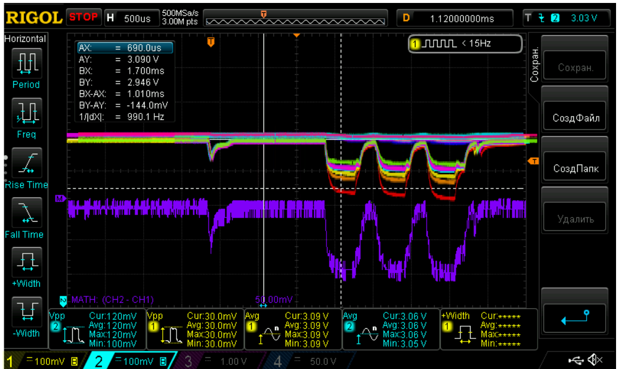
Рисунок 7.2 – Зведена осцилограма падіння напруги на резисторі для встановленої потужності передачі від -40 дБм до +4 дБм
