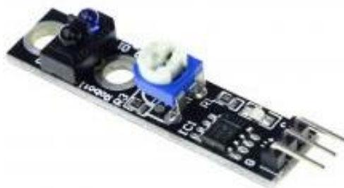
Рисунок 1.7 – Датчик ліній KY-033 на TCRT5000 [15]
