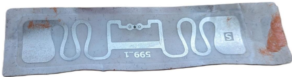
Рисунок 1.3 – Приклад RFID-мітки в пакуванні насіннєвій компанії ТОВ «КВС»
