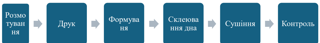
Рисунок 2.2 – Технологічний процес виготовлення паперових мішків
