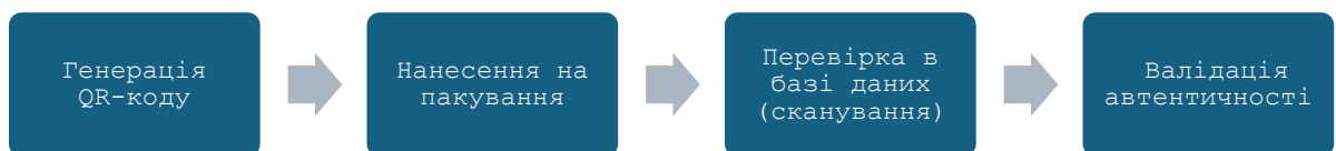
Рисунок 1.4 – Принцип роботи системи trace & track
