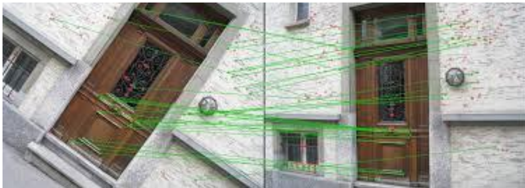
Рисунок 1.2 – Візуалізація пошуку ключових точок алгоритмом BRISK
