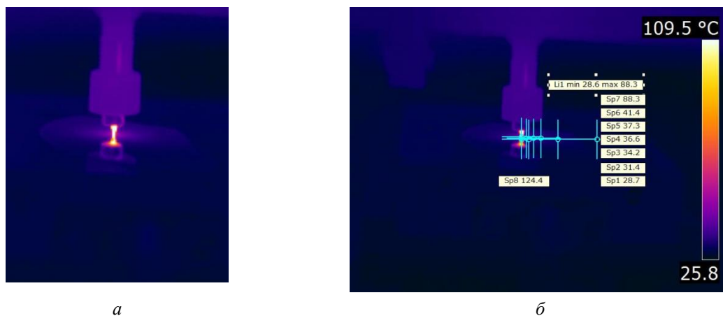
Рис. 10. Термограмма для случая касания зондом кремниевой подложки. Тепловое поле (а) и температуры в точках подложки Sp1...Sp7, расположенных по радиусу области с центром на кончике рабочего зонда Sp8 (б)
