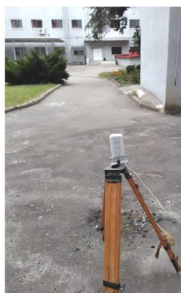
Рис. 8. Экспериментальная линия связи (а) диапазона 60 ГГц на основе радиомодемов MikroTik Wireless Wire (б)
