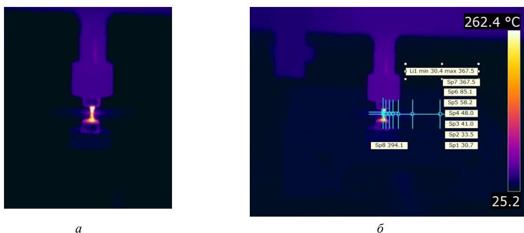
Рис. 9. Термограмма для случая касания зондом подложки из поликора с пленкой фоторезиста. Тепловое поле (а) и температуры в точках подложки Sp1...Sp7, расположенных по радиусу области с центром на кончике рабочего зонда Sp8 (б)
