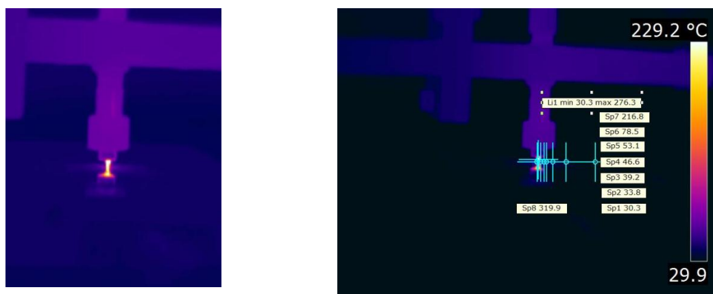
Рис. 8. Термограмма разогрева подложки из поликора с пленкой фоторезиста. Тепловое поле (а) и температуры в точках подложки Sp1...Sp7, расположенных по радиусу области с центром на кончике рабочего зонда Sp8 (б)
