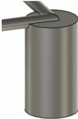
Рисунок 3.68 – Фіксація сегментів до мідної пластини
