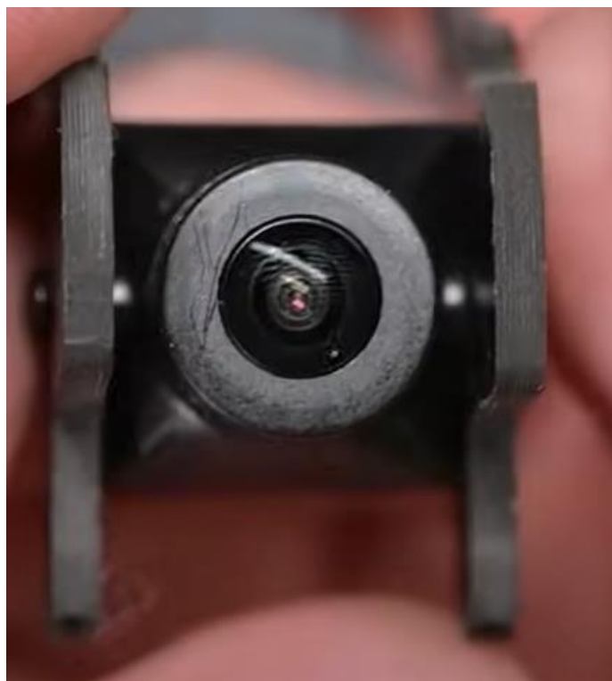
Рисунок 3.15 – Встановлення камери в раму з Mark 4
