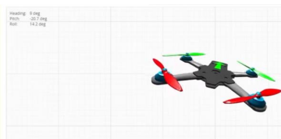
Рисунок 3.36 – Модель нахилу дрону в BetaFlight
