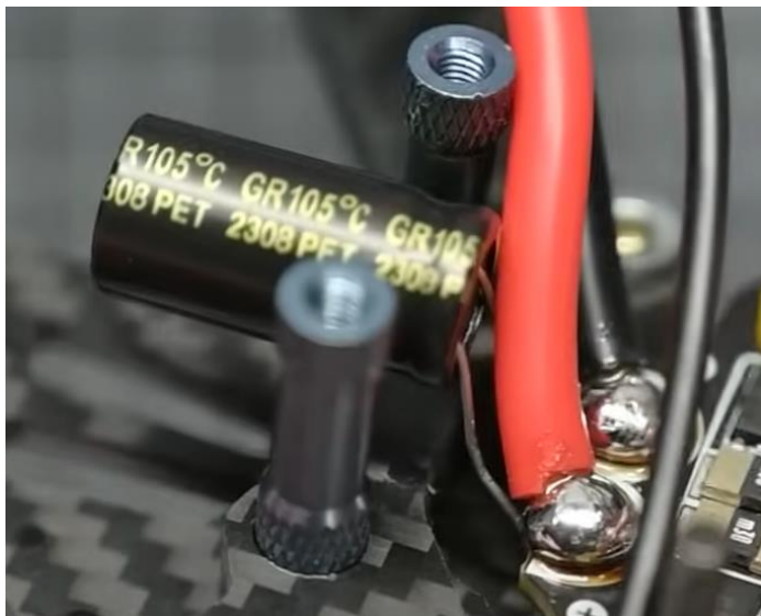
Рисунок 3.8 – Результат паяння конденсатора та силових дротів
