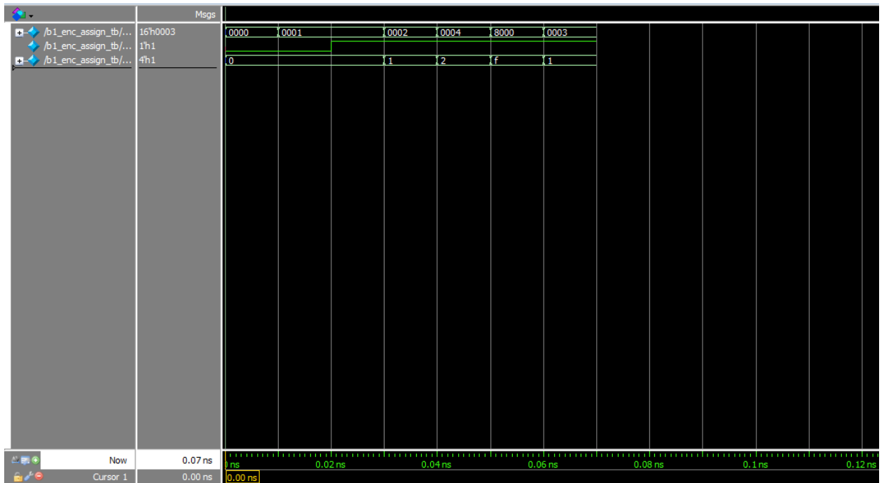
Рисунок 3.2 – Результати моделювання роботи неперіоритетного шифратора на основі оператора безперервного присвоєння assign
