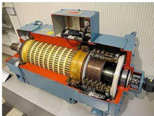
Рис. 15.9 – Двигун постійного струму в розрізі. Праворуч розташований колектор з щітками
