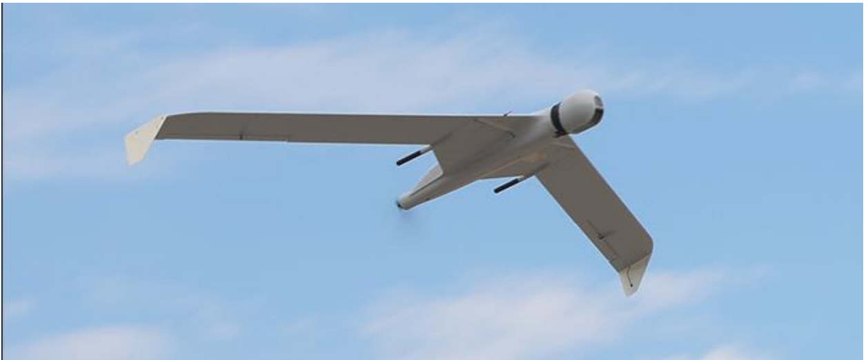
Рисунок 1.2 – Безпілотний літальний апарат ZALA 421-16E-Ф
