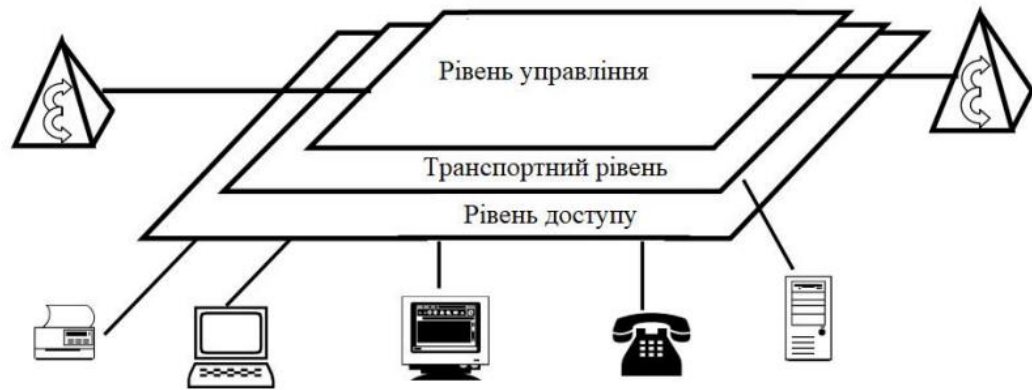
Рисунок 1.1 - Архітектура мультисервісної мережі
