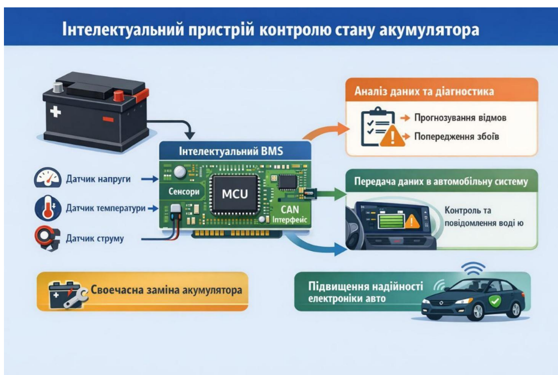
Рис. 1 – Приклади інтелектуального пристрою контролю стану акумулятора
