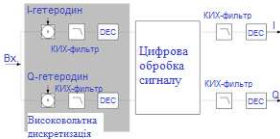
Рисунок А.3 – Стандартна цифрова архітектура перетворення сигналу зі зниженням частоти
