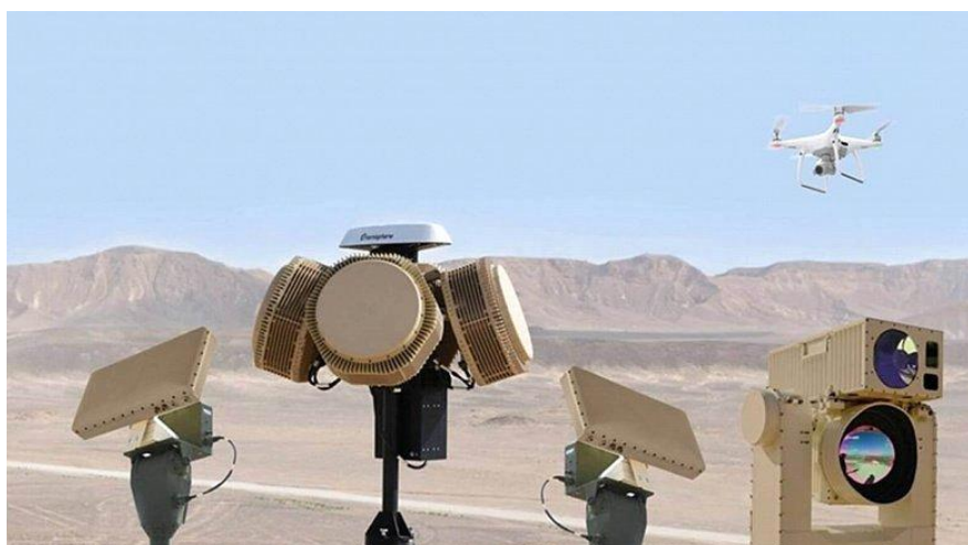
Рисунок 1.10- Система виявлення дронів
