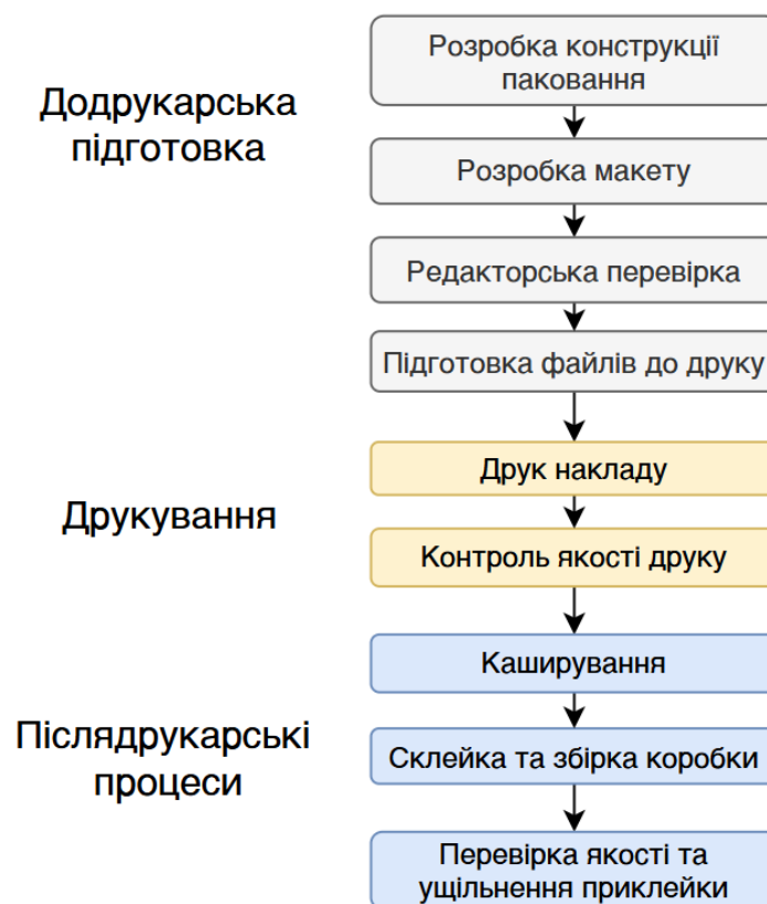
Рисунок 3.1 – Структурна схема технологічного процесу виготовлення пакування настільної гри
