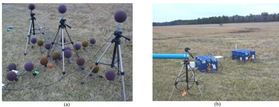
Рисунок 1.3 - (a) 16-Х масив, розташований на землі, та піднятий мікрофон для 4-L масиву на центральному штативі та (b) Система збору даних "Blue Box" використовується як система для збору даних.
