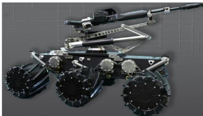
Рисунок 1.2 – Ударна роботизована платформа «Цитрус», що має на озброєнні РШГ-16, РПГ-16, пневматичну установку та бур
