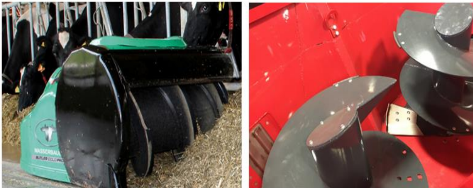
Рисунок 1.1 – Шнековий робот-підгортач Butler Gold (а) та фрагмент конструкції робота-змішувача кормів Rovibec (б)
