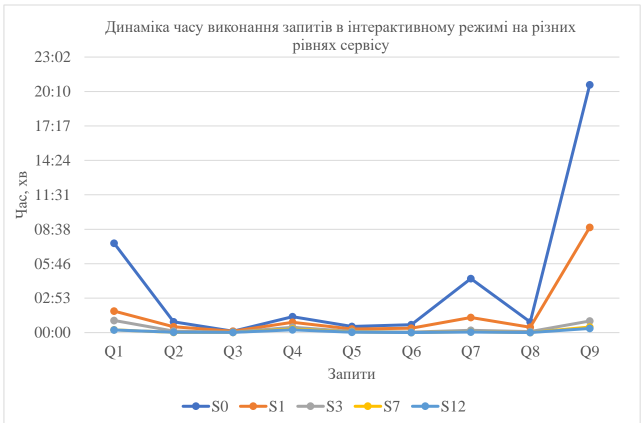
Рисунок 3.12 – Графік динаміки часу виконання запитів в інтерактивному режимі на різних рівнях моделі
