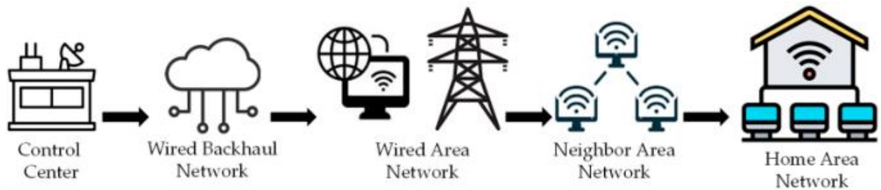
Рисунок 1.2 – Напрямок потоків даних у мережах SMART GRID
