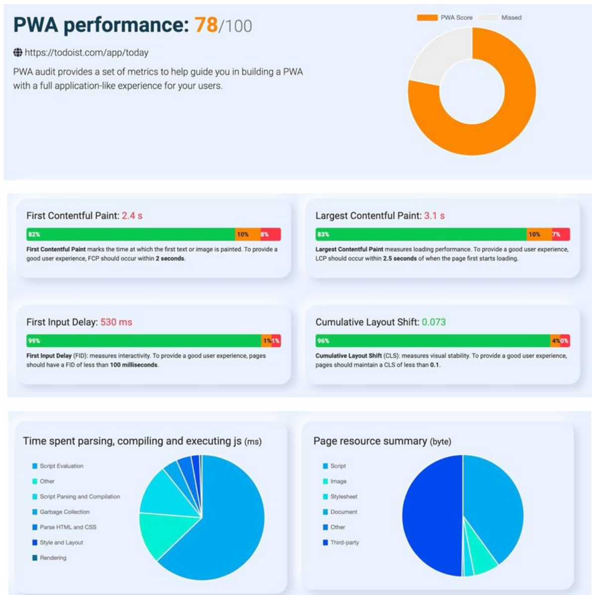
Рисунок 3.8 – Результат проведення автоматизованого тестування продуктивності PWA додатку
