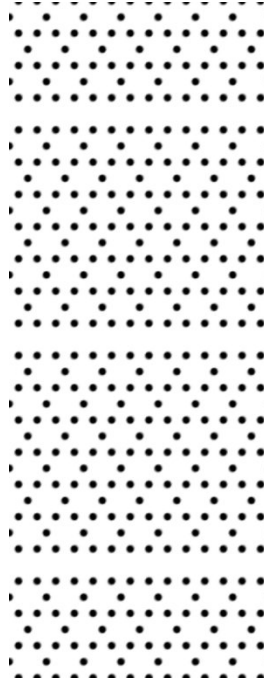
Рисунок 2.10 – Схема трьох періодів надкомірки фотонно-кристалічного хвилеводу
