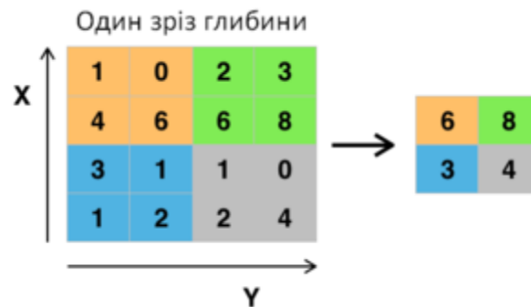
Рисунок 1.10 – Максимізаційне агрегування з фільтром 2x2 та кроком 2
