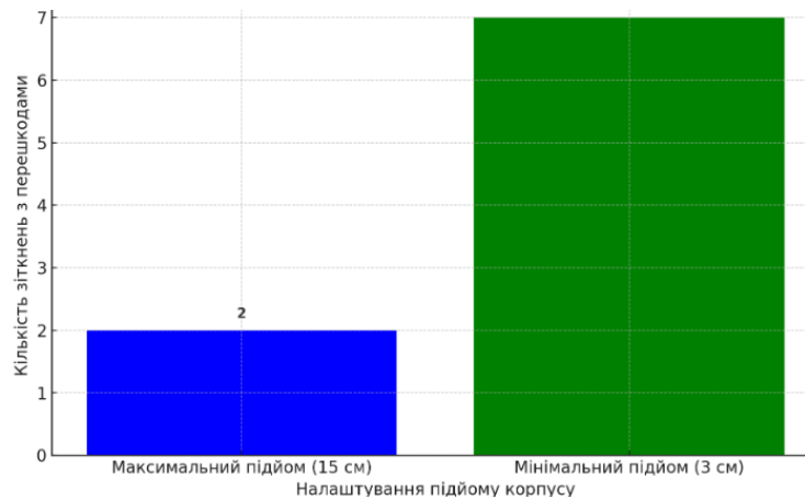
Рисунок 3.2 – Графік кількості зіткнень з перешкодами, порівняння кількості зіткнень робота з перешкодами при різних налаштуваннях підйому корпусу
