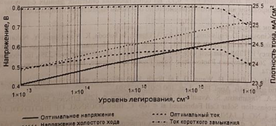
Рис. 3 — Зависимость напряжений и тока от уровня легирования кремния
