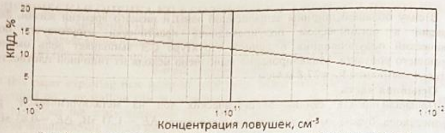
Рис. 4 — Зависимость КПД СЭ от концентрации ловушек кремния
