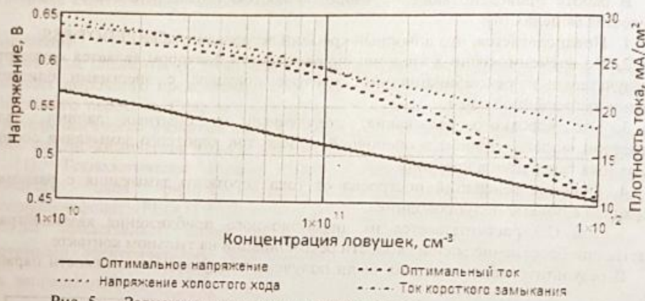
Рис. 5 — Зависимость напряжений и тока от концентрации ловушек
