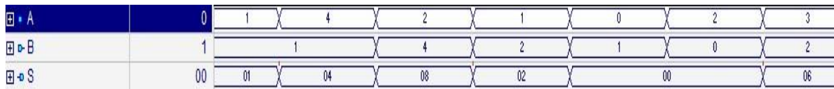
Рис. 2.4 – Часова діаграма роботи матричного пристрою множення з горизонтальним переносом
