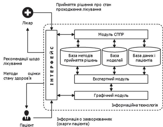
Рис. 6. Загальна функціональна схема ІТ у вигляді СППР
