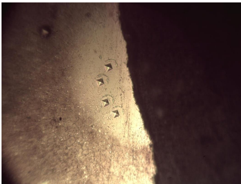
Рисунок 3 Сталь P6M5, многоимпульсная обработка, длительность импульса 60 мкс.
