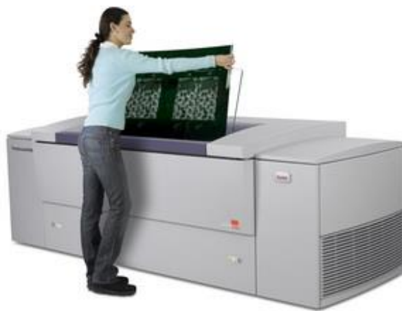
Рисунок 7.3 – Цифрова флексографська система Kodak Flexcel NX
