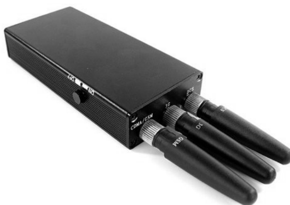
Рисунок 1.13 – Пригнічувач мобільних телефонів «БагХантер PS-1»
