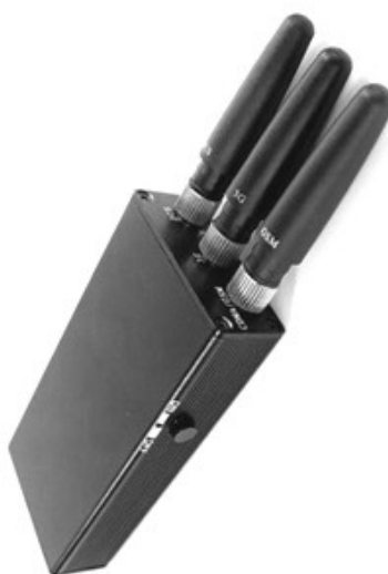
Рисунок 1.12 – Пригнічувач мобільних телефонів GSM, 3G «Скорпіон 10»
