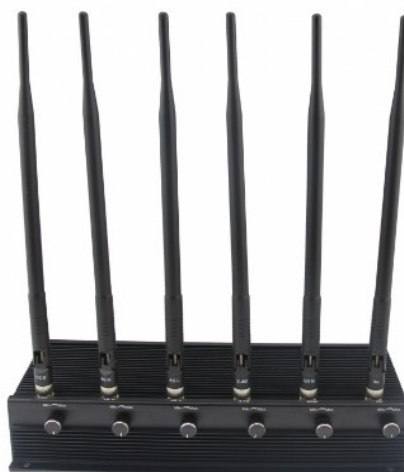
Рисунок 1.11 – Пристрій пригнічування систем стільникового зв'язку "ПІРАНЬЯ Х6-4G"
