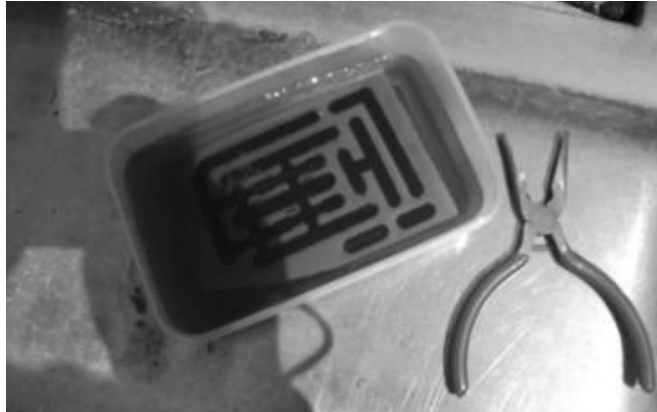
Рисунок 3.3 – Травлення друкованої плати
