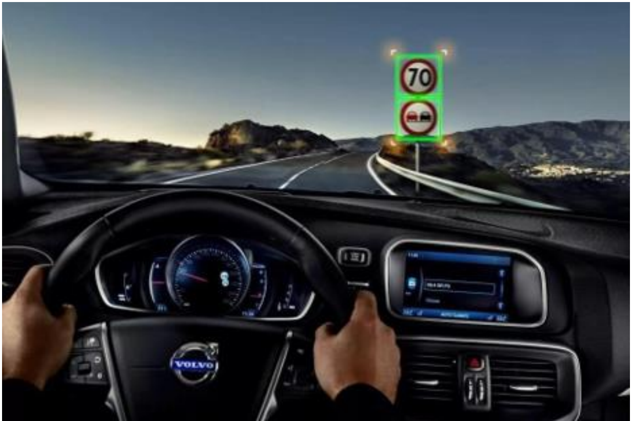
Рисунок 1.6 – Приклад роботи системи Road sign information
