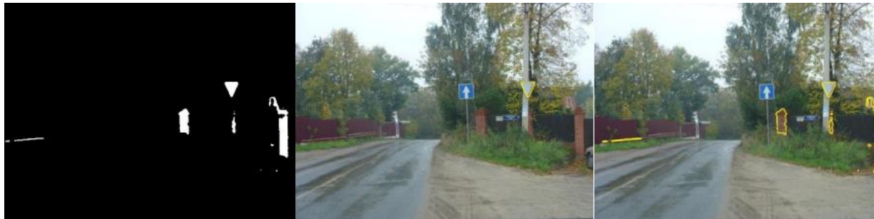
Рисунок 2.3 – Знаходження контурів, де може знаходитися знак та фільтрація контурів
