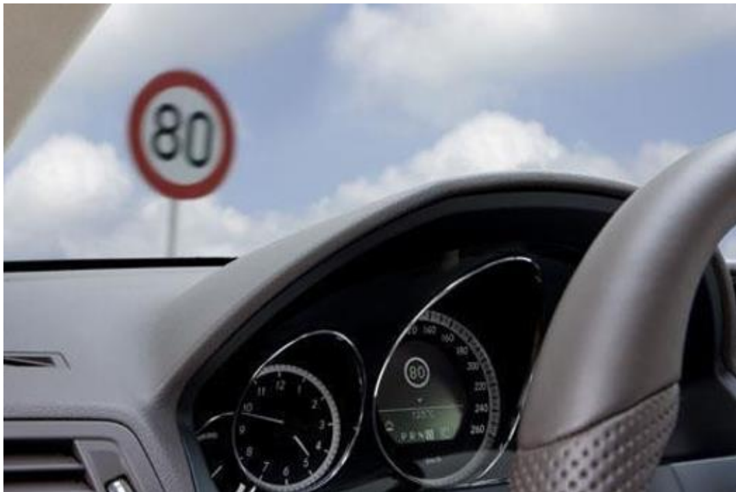
Рисунок 1.5 – Приклад роботи Speed limit assist
