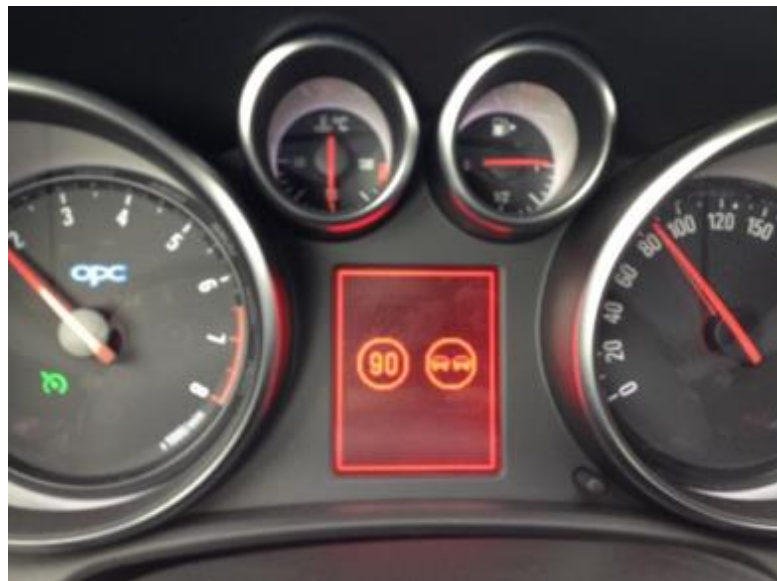
Рисунок 1.4 – Приклад роботи Opel Eye
