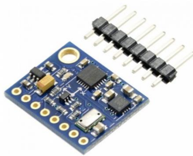
Рисунок 3.4 – Зовнішній вигляд комбінованого модуля GY-86
