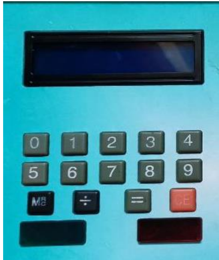
Рисунок 1.12 – Клавіатура та дисплей, вмонтовані у блок намотування
