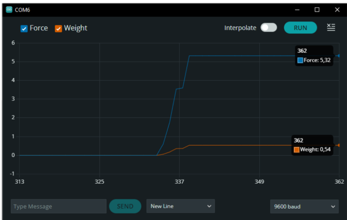
Рисунок 3.7 – Дані отримані з тензодатчика при навантаженні в 542 грами
