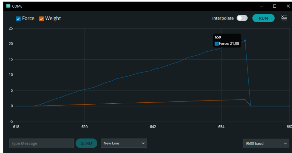
Рисунок 3.10 – Графік сили натягу дроту діаметром 0,35 мм
