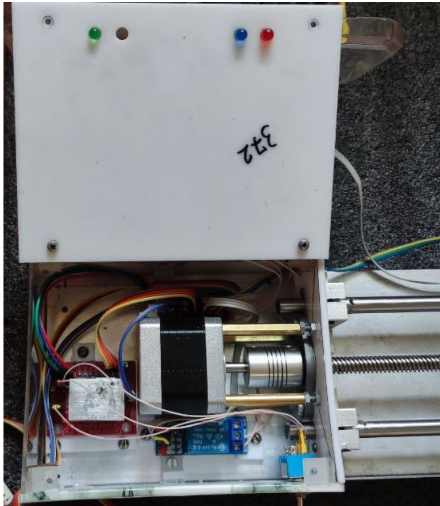
Рисунок 1.9 – КД з'єднаний муфтою, драйвер, реле та світлодіоди встановлені на основу укладача
