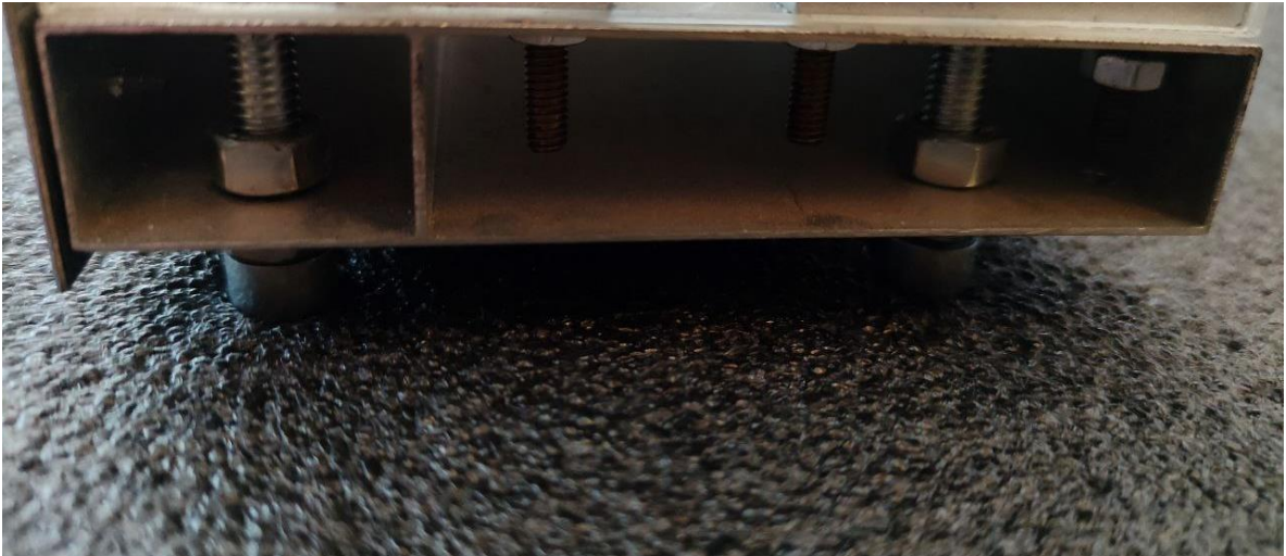
Рисунок 1.4 – Основа закріплення напрямних у вигляді алюмінієвого профіля
