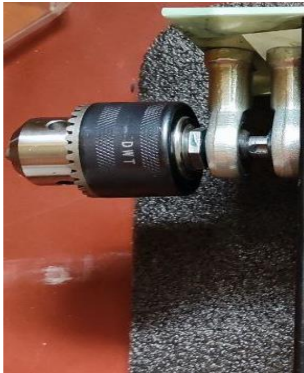
Рисунок 1.10 – Патрон закріплений на опорі з підшипниками
