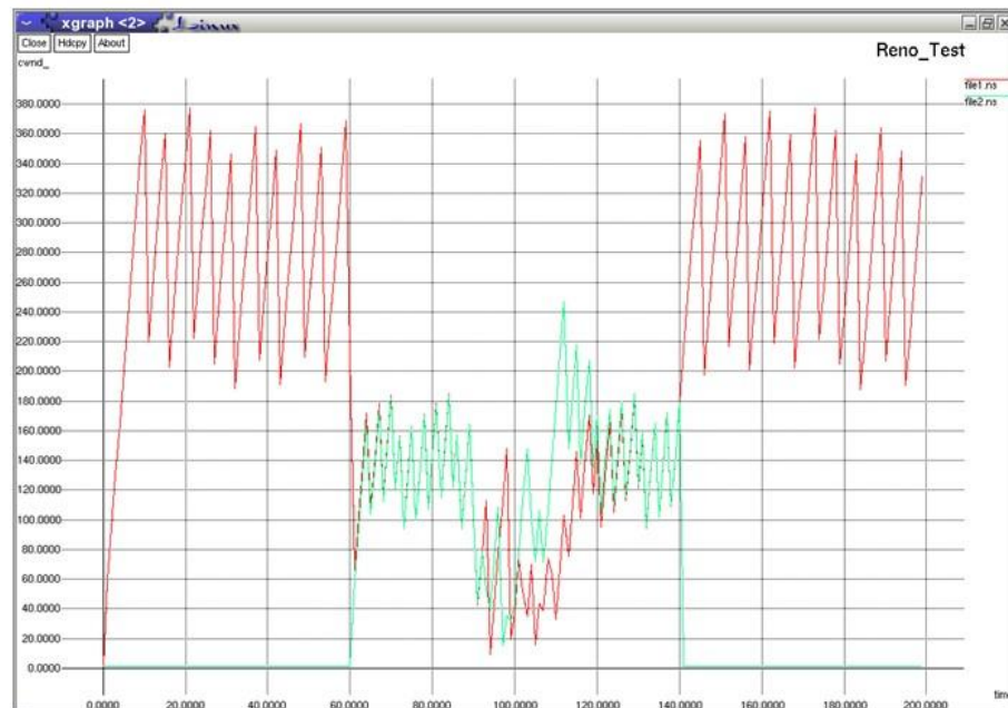
Залежність пропускної здатності від часу для з'єднань протоколом TCP Reno, запропонованою модифікацією протоколу TCP NewReno і наявності фонового трафіку
