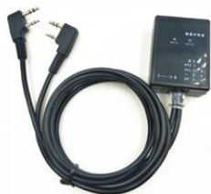
Додатковий блок з'єднання Радіостанцій ретранслятора
