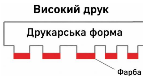
Рисунок 5.1 – Схематичне зображення друкарської форми високого друку
