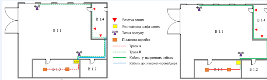
Траси кабелю в будівлі В
