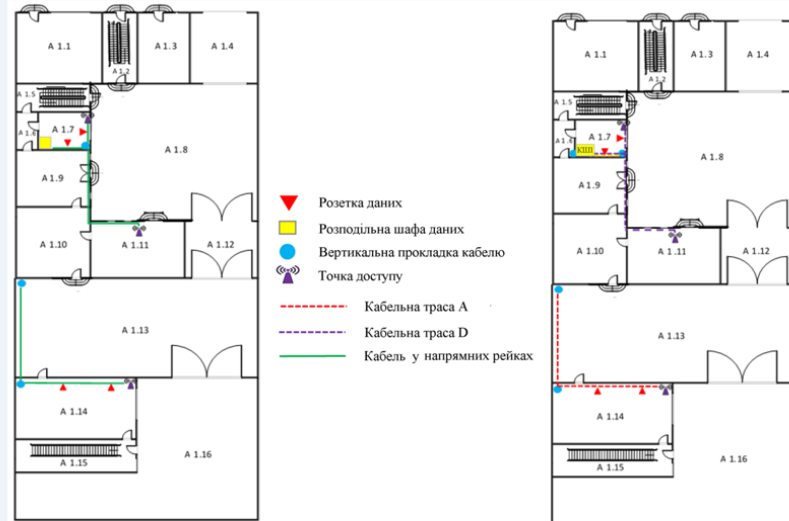
Траси кабелю на першому поверсі будівлі А
