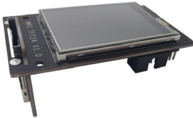
Рисунок 2.5 – Сенсорний дисплей MKS TFT24
