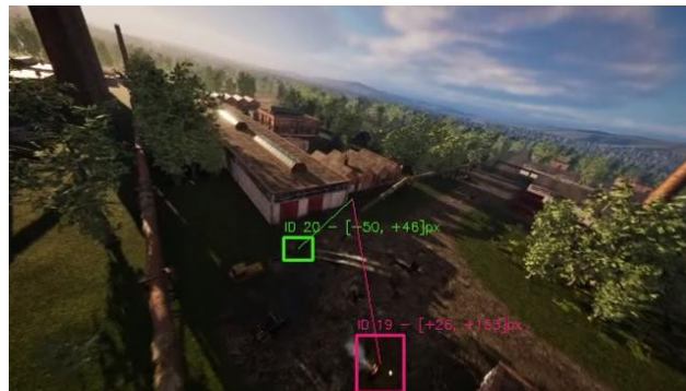
Рисунок 4.1 – Приклад супроводження цілі в умовах короточасного перекриття та зміни ракурсу спостереження із візуалізацією вектора відхилення [\Delta X, \Delta Y]
