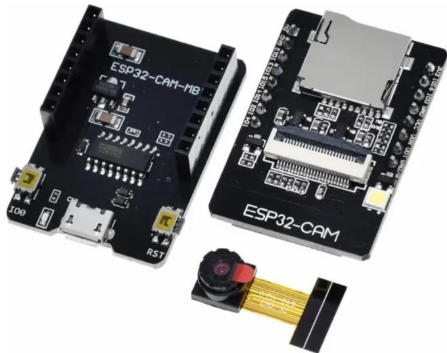
Рисунок 3.1 – Зовнішній вигляд плати ESP32-CAM, CMOS-камери OV2640 та плати програмування [23]
