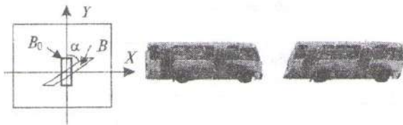
Рис. 1. Косой сдвиг B_0(x, y) = B(x + y \operatorname{tg}(\alpha), y) , где \alpha — угол сдвига
