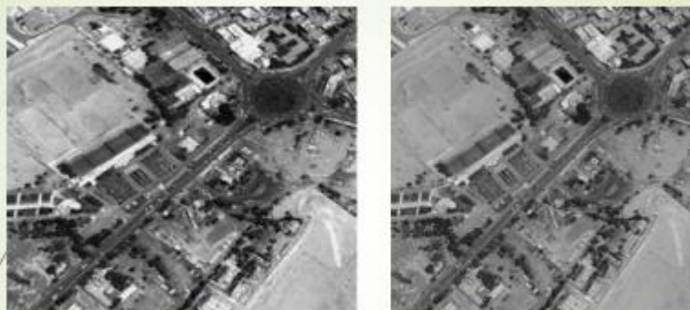
Рисунок 9 - Комплексоване зображення: а) отримане на основі вихідних оптичного і радіолокаційного зображень; б) початкове оптичне зображення в градаціях сірого
