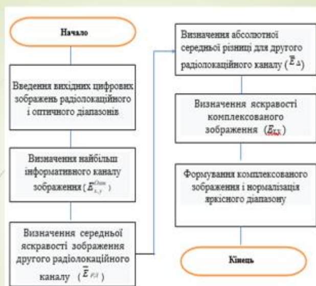
Рисунок 10- Блок-схема узагальненого алгоритму комплексування зображень
