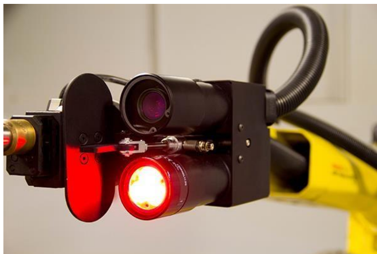
Рисунок 2.2 – Маніпулятор Fanuc Corporation зі вбудованою камерою
