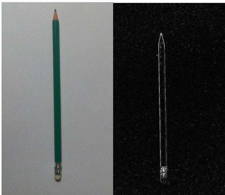
Рисунок 3.19 – Визначення контуру ручки оператором Лапласа
