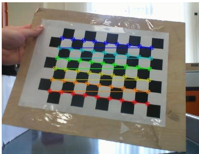
Рисунок 3.12 – Калібрувальний шаблон із знайденими кутами
