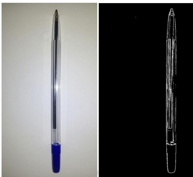
Рисунок 3.22 – Визначення контуру ручки з детектором Собеля
