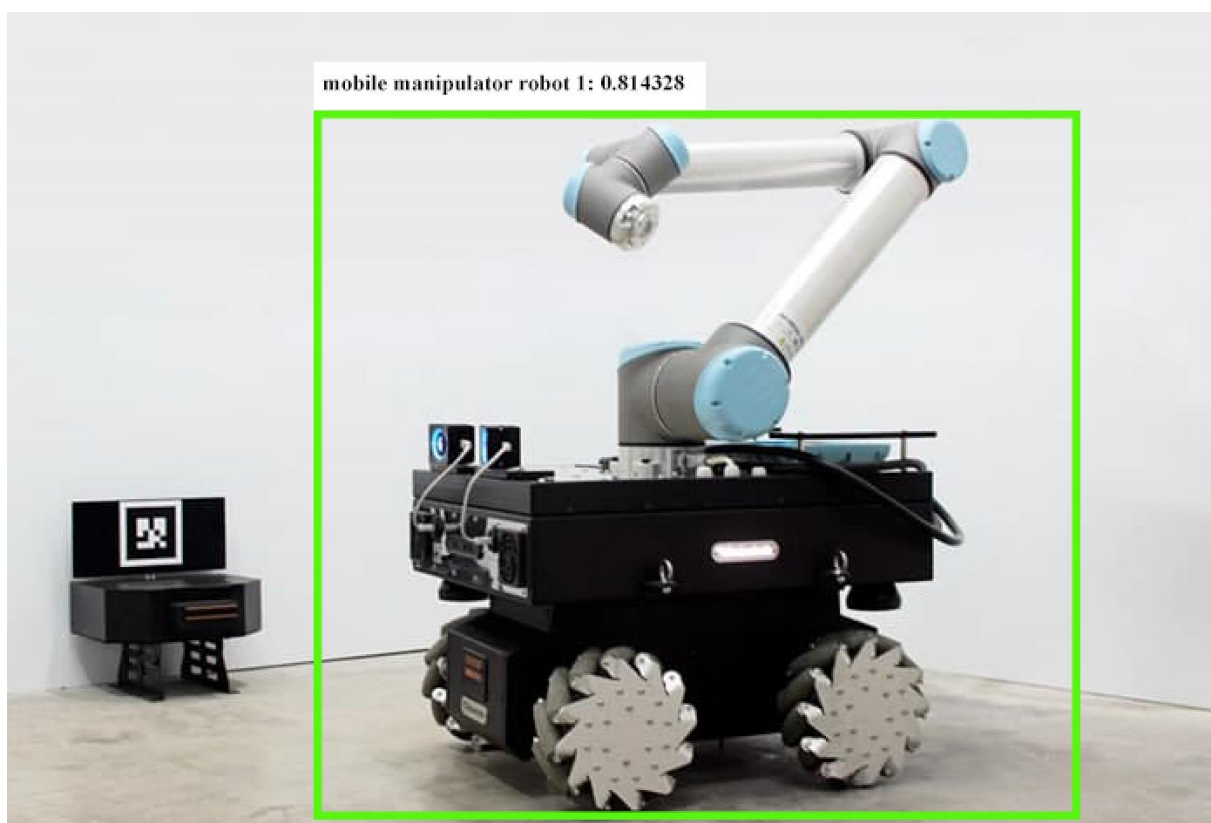
Рисунок 5.6 – Результати розпізнавання транспортних технологічних об'єктів за допомогою мережі яка використовує згорткові шари в архітектурі
