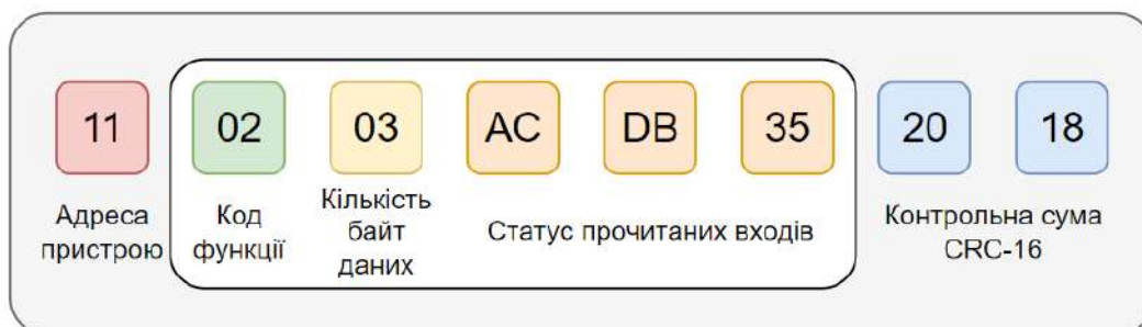
Рисунок 4.12 – Приклад відповіді на запит читання дискретних входів
