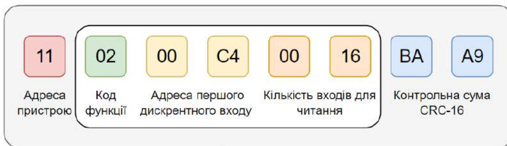
Рисунок 4.11 – Приклад запит для читання дискретних входів 10197-10204
