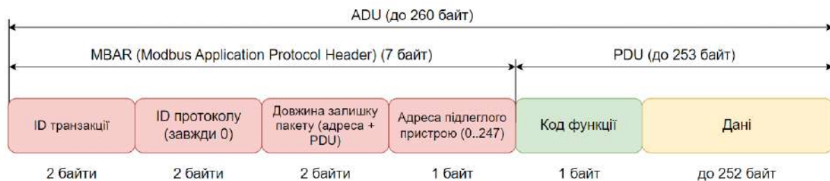
Рисунок 4.8 – Структура пакету протоколу Modbus TCP
