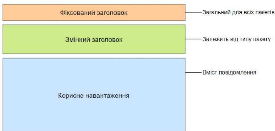
Рисунок 3.13 – Загальна структура повідомлення MQTT
